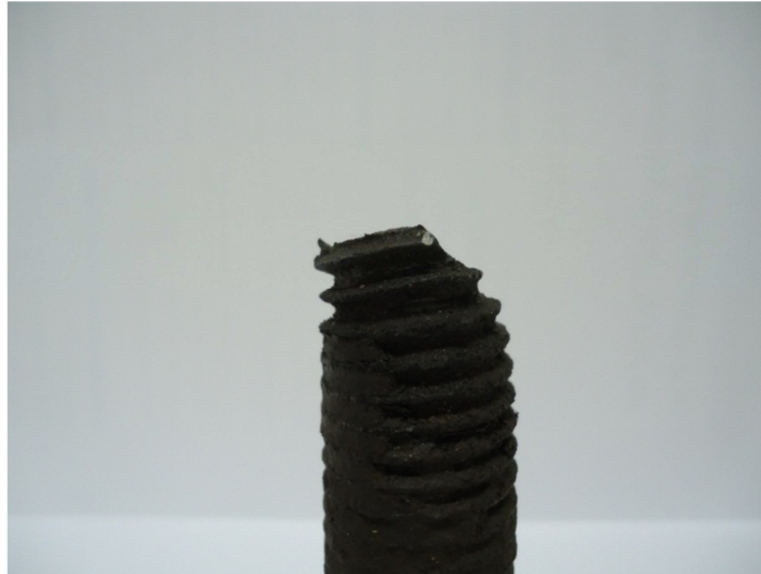
FIGURA 18 – Parafuso LOC03: filetes de rosca parcialmente preenchidos com uma mistura de graxa e pós.
