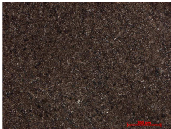
FIGURA 40 – Microestrutura do centro do parafuso LOC04. Martensita revenida, ataque com Nital 2%, aumento de 100X.
