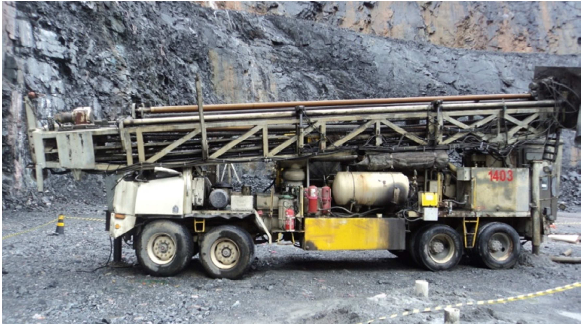
FIGURA 01 – Queda do mastro sobre a cabine do caminhão perfuratriz.
