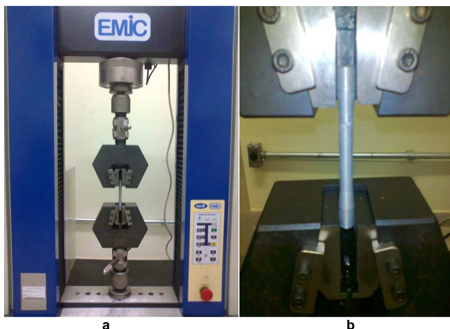
Figura 29: Corpos-de-prova sob tração.a) corpo sob tração b)corpo já apresentando fratura.
