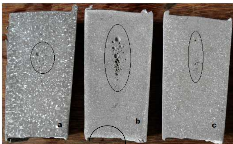
Figura 31: Macroestrutura dos lingotes de Al-Cu a) Al-2%Cu, b) Al-3%Cu e c) Al-4%Cu todos os lingotes fundidos sob 43 MPa.
