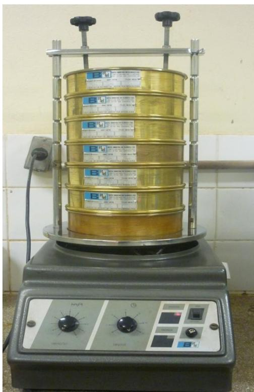
Figura 12 - Ensaio granulométrico das amostras de solo.
