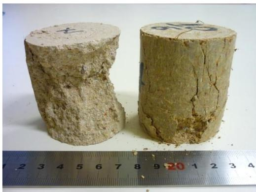
Figura 39 - Fratura dos corpos de prova após ensaio de resistência à compressão.
