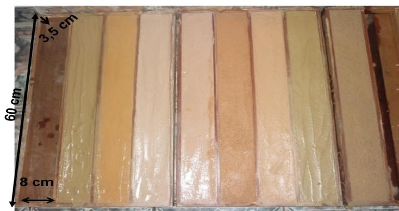
Figura 14 - Ensaio de retração do solo (ordem AS1 até AS8).
