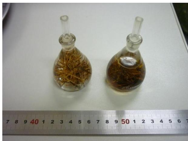
Figura 16 - Ensaio de massa específica real das fibras tratadas e não tratada.
