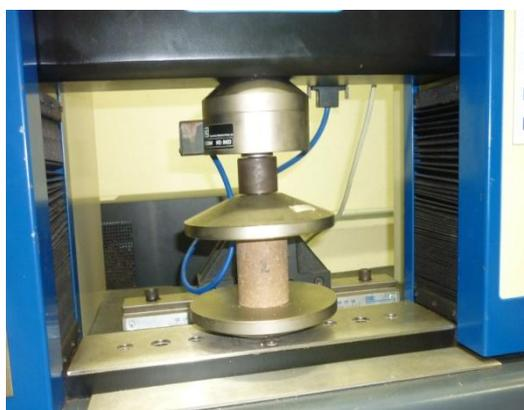
Figura 19 - Ensaio de Resistência à compressão.
