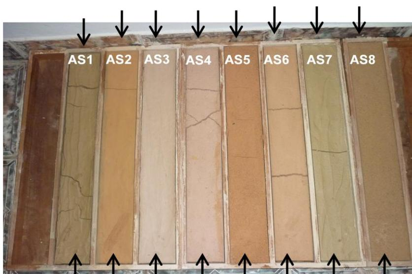
Figura 32 - Ensaio de retração do solo após 7 dias.
