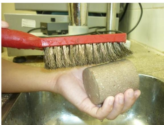
Figura 21 - Escovação dos corpos de prova.
