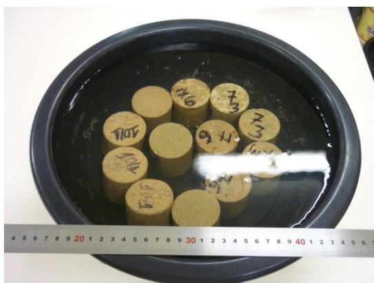
Figura 20 - Corpos de prova imersos em água.
