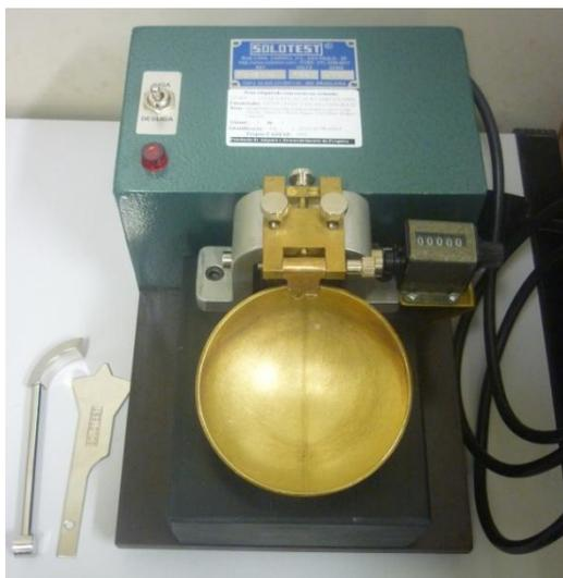
Figura 13 - Aparelho de Casagrande.
