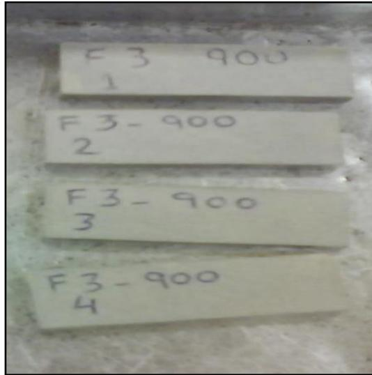
**Figura 8** – Corpos de prova a verde após prensagem
