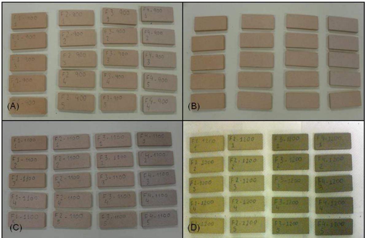
**Figura 9** – Corpos de prova após sinterização; (A) 900°C; (B) 1000°C; (C) 1100°C e (D) 1200°C.
