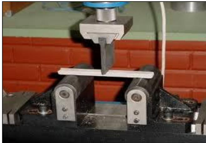
**Figura 10:** Ensaio para determinação do Módulo de Ruptura à Flexão
