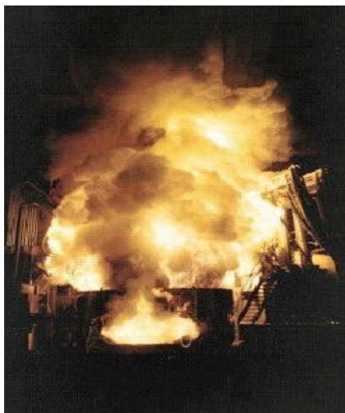
Figura 5. Emissão de fumos durante o vazamento de aço em forno elétrico.
