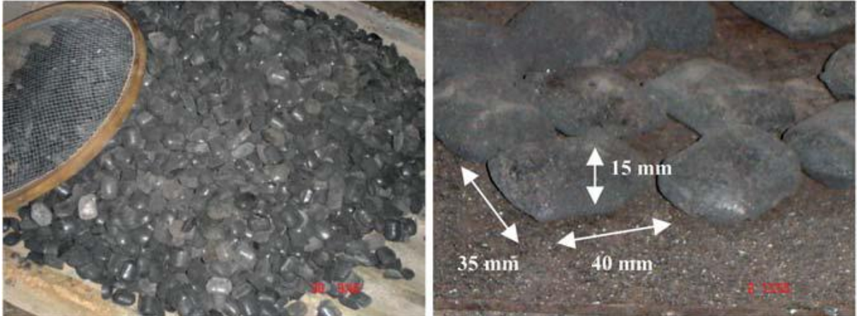
Figura 10. Briquetes de carepa fabricados.
