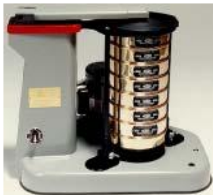
Figura 13: Peneirador vibratório, do tipo ro-tap, utilizado nos ensaios de resistência à abrasão.
