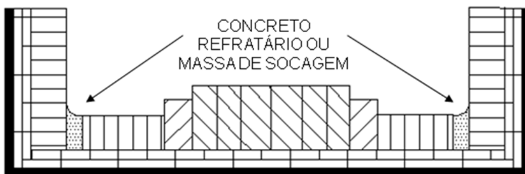
Ilustração 9 - Desenho esquemático de panela com fundo livre. Fonte: OLIVEIRA, 1997.
