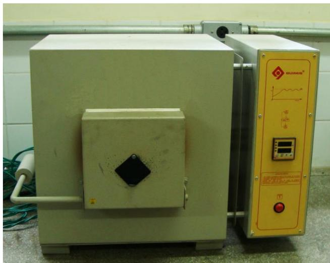
**Figura 3.17** – Forno mufla para tratamentos térmicos.
