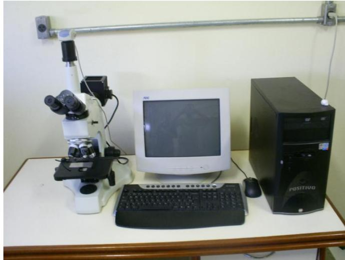
**Figura 3.15** – Microscópio óptico com interface com microcomputador.
