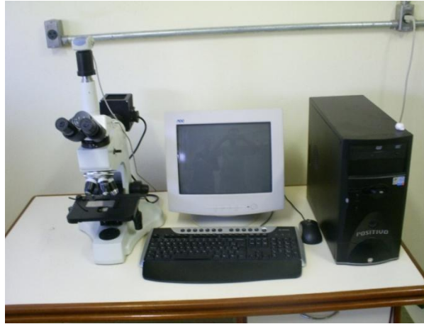
Figura 3.12 – Microscópio ótico com interface com microcomputador.
