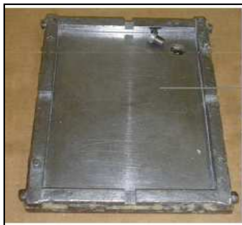
Figura 13. Molde metálico utilizado para confecção dos compósitos.
