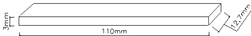
Figura 3.6: Corpo-de-prova para ensaio de tração.
