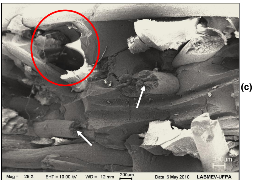
Figura 28 - (a), (b) e (c) Micrografia obtida por MEV da superfície de fratura dos compósitos reforçados com 46,06% de fibras de Babaçu tratadas com 10% de NaOH. 270, 410 e 290x respectivamente.
