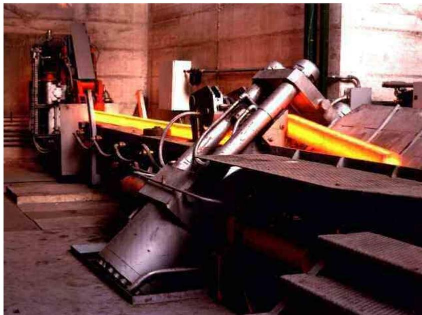
FIGURA 18: Tesoura hidráulica.
