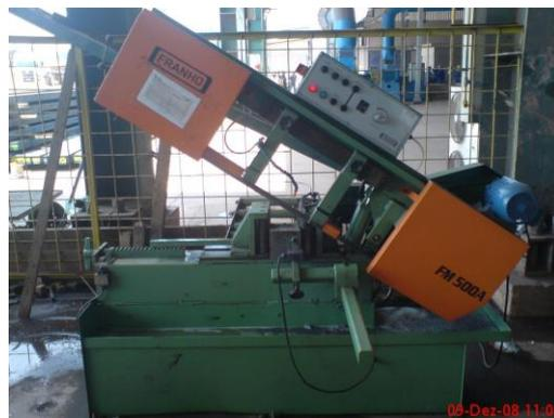
FIGURA 30: Máquina de Serra Fita Horizontal. MODELO: FM 500A, fabricante FRANHO.
