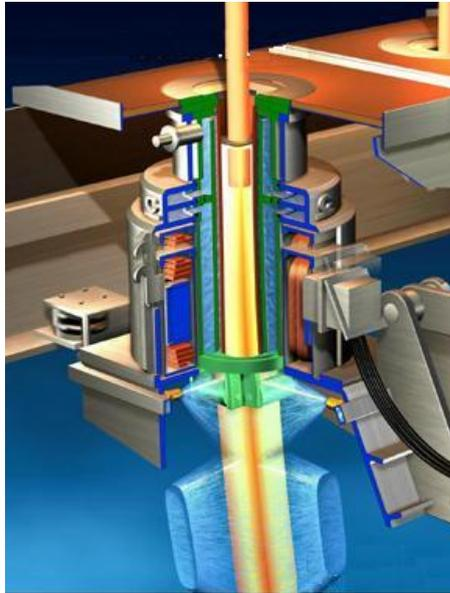
FIGURA 10: Desenho do molde abastecido com aço líquido.
